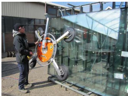
Es. di dispositivo di sollevamento a ventosa Montaggio lastre con robot dotato di braccio a sollevamento telescopico e ventose
